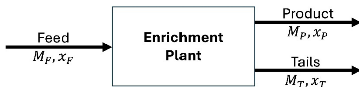
図 1 濃縮プラントにおける材料の流れ
